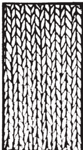
Rysunek 10 Splot interlokowy prawa strona
