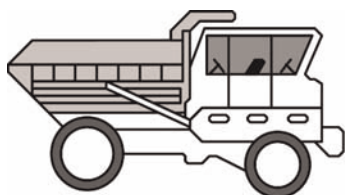
Wywrotka z siedzeniem dwupołożeniowym i dwoma układami sterowania
