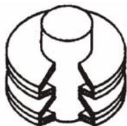
Kolumnowa sprężyna talerzowa (przekrój perspektywiczny)
